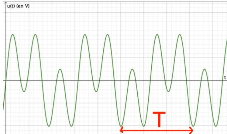
L'amplitude est la valeur maximale de la grandeur prise par le signal périodique. Elle se note  $U_{\max}$  (ou  $I_{\max}$ ).
