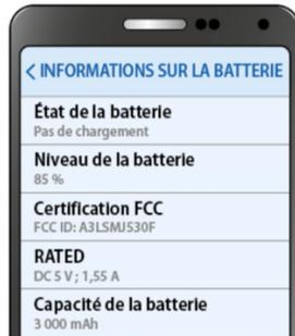
L'énergie en Wh stockée dans la batterie se calcule en faisant le produit de la tension par la capacité.
