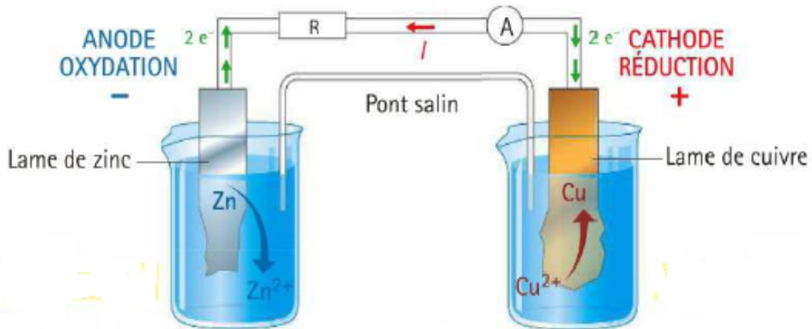
La première demi-pile contenant le couple  $\text{Zn}^{2+}_{(\text{aq})} / \text{Zn}_{(\text{s})}$  est le siège d'une oxydation :
