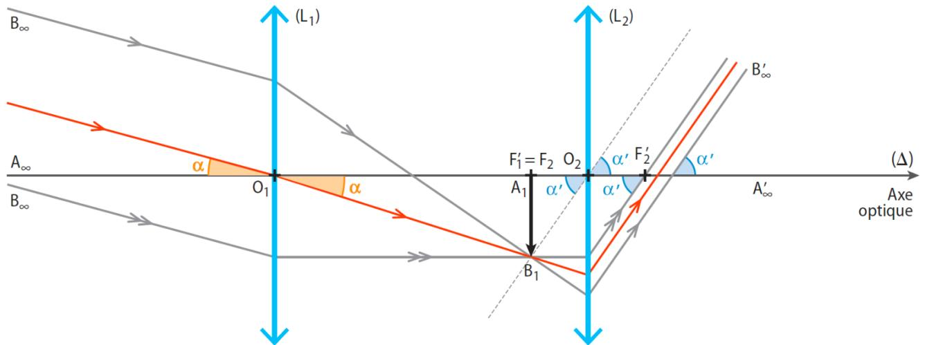
1.3. La taille de  $A_1B_1$  est  $A_1B_1 = f'_1\alpha = 8,40 \text{ mm}$ .
